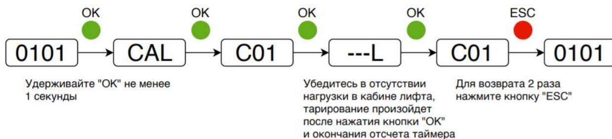
Рисунок 14 - Процедура быстрого тарирования
