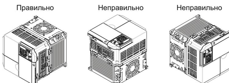
Рисунок 2.1 Правильное расположение при монтаже
