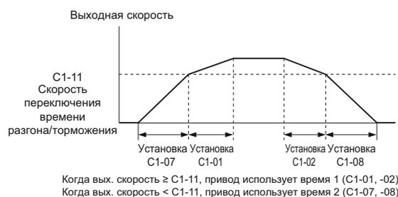
Рисунок 5.4 Скорость переключения разгона/торможения
