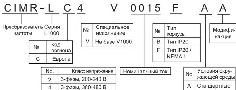
Рисунок 1.2 Расшифровка кода модели
