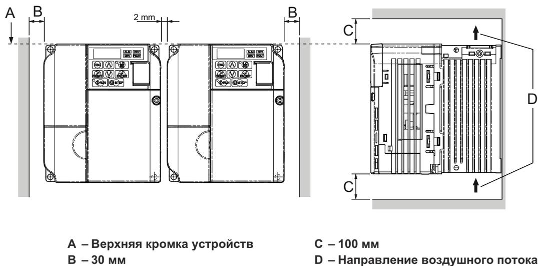
Рисунок 2.3 Расстояние между приводами частоты (монтаж "стенка к стенке")
