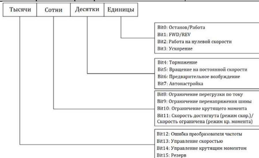
Рисунок 7-2 Состояние работы преобразователя частоты
