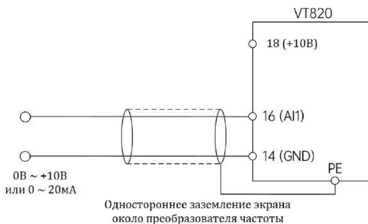
Рисунок 4-7 Подключения несимметричного входа клеммы 16
