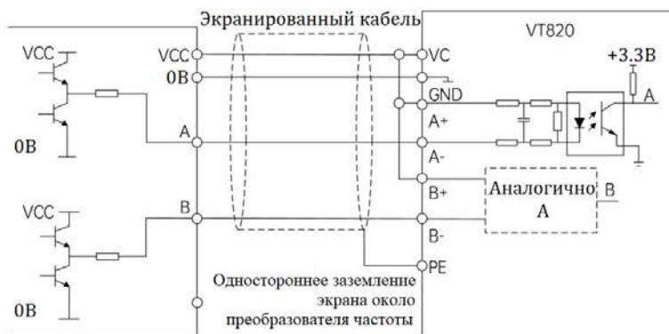
Рисунок 4-23 Схема подключений двухтактного PG
