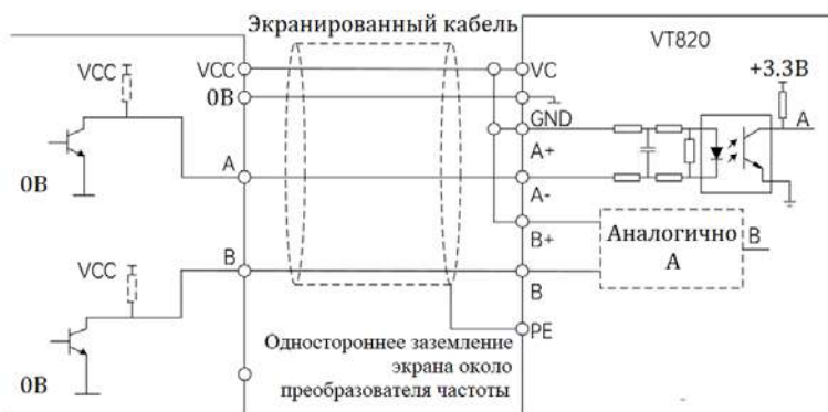
Рисунок 4-22 Схема подключений PG с открытым коллектором
