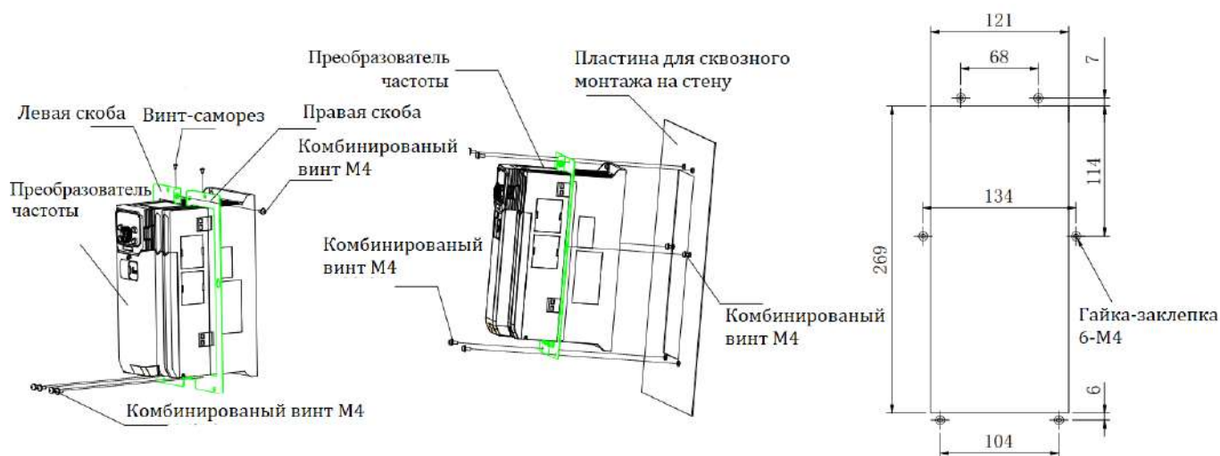
Рисунок 2-26 Комплект встроенного монтажного кронштейна VT810-EMBC
