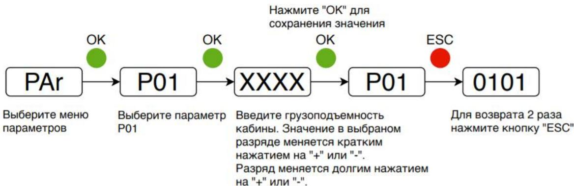
Рисунок 13 – Процедура ввода номинальной нагрузки
