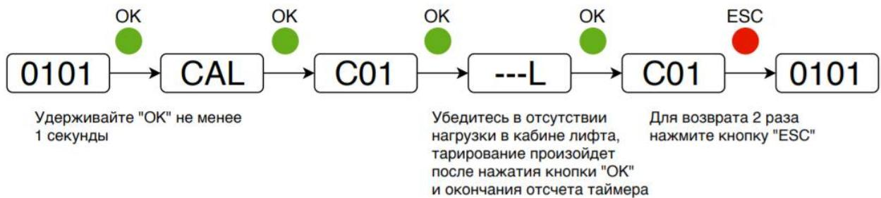
Рисунок 14 - Процедура быстрого тарирования
