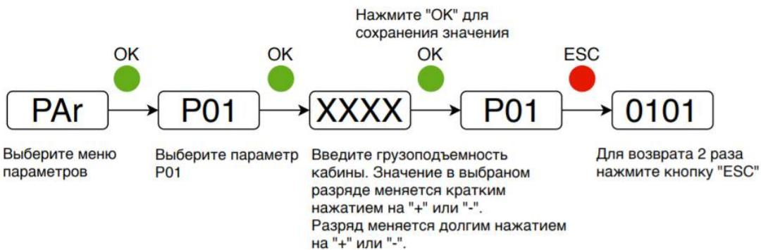
Рисунок 13 – Процедура ввода номинальной нагрузки
