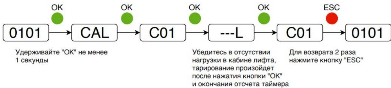
Рисунок 14 - Процедура быстрого тарирования
