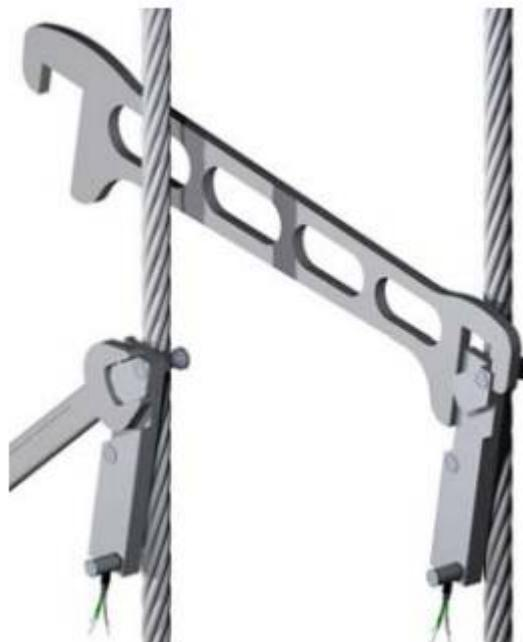
Рисунок 8 – Способ монтажа канатных тензодатчиков при помощи гаечного
