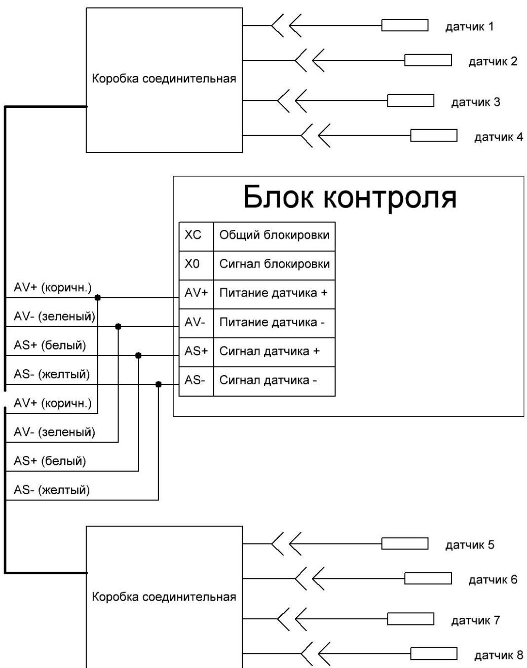
Рисунок 9 - Подключение тензодатчиков
