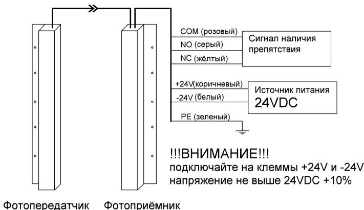
Рисунок 1 - Электрическое подключение фотоэлектрического барьера
